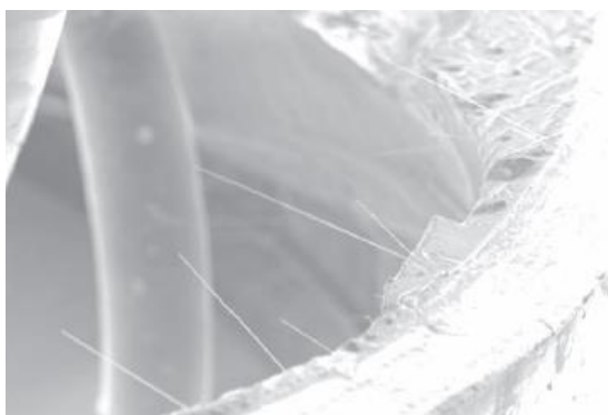
Obr. 33: Cínové whiskery uvnitř pocínovaného pouzdra germaniového tranzistoru AF114. Rok výroby 1960, rok pozorování 2005.[61]
