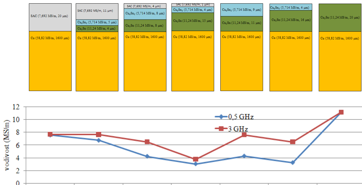
Obr. 92: Znáornění situace, kdy ve struktuře pájeného spoje dochází k růstu vrstev intermetalických sloučenin na úkor pájky, až dojde k úplnému „pohlčení“, a odpovídající vypočítaná vodivost ve vybraných fázích pro 2 úrovně frekvence.
