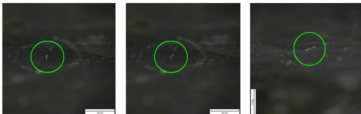
Obr. 57: Růst cínového whiskeru z pájky Sn-1Cu, postupný růst po 1000, 2000 a 3000 hodinách. Měřítka je 500 \mu\text{m} .
