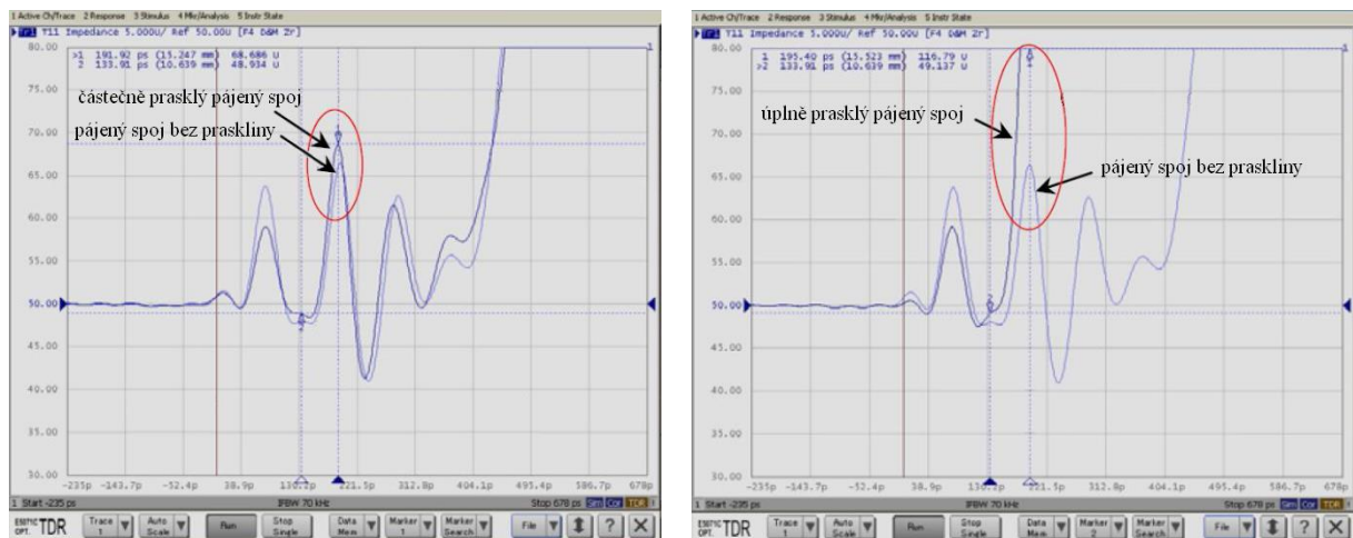
Obr. 23: Demonstrace možnosti identifikovat částečně i úplně prasklý pájený spoj pomocí měření vysokofrekvenční impedance v časové oblasti. [55]
