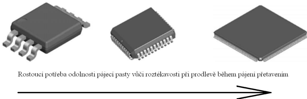
Obr. 13: S přechodem na jemnější rozteč vývodů roste potřeba odolnosti pájecí pasty proti roztékání během prodlevy při pájení přetavením. Nejnáchylnější jsou součástky s velmi jemnou roztečí vývodů. [18]
