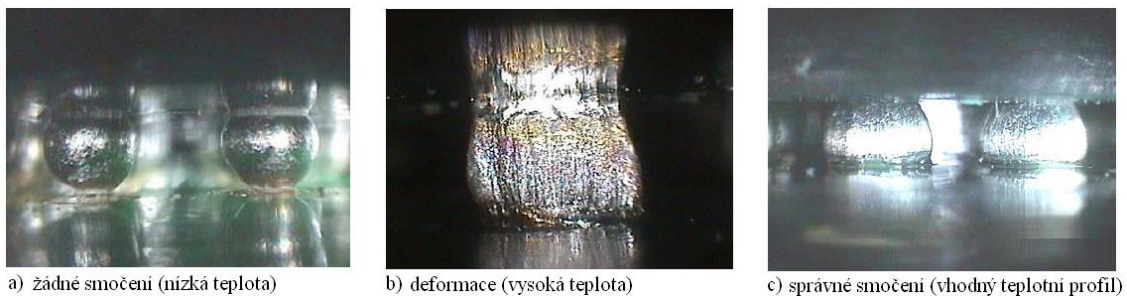
Obr. 7: BGA vývody, vliv vhodné teploty na správné připájení vývodů. [10]
