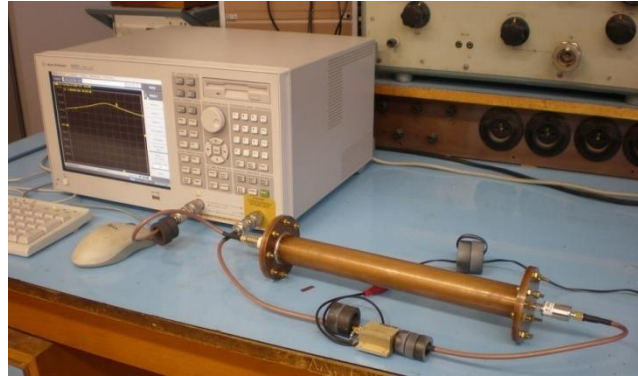
Obr. 89: Měřicí pracoviště, připojení rezonátoru do měřicího obvodu. [98]
